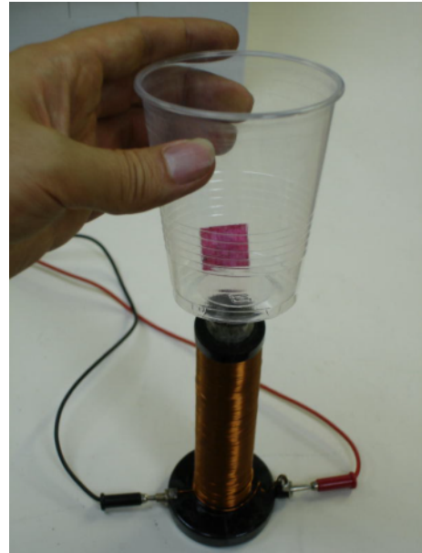
写真8 コイルの上で踊る磁石
