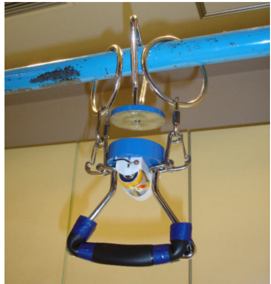
写真4 電磁石に取り付けた落下防止装置
