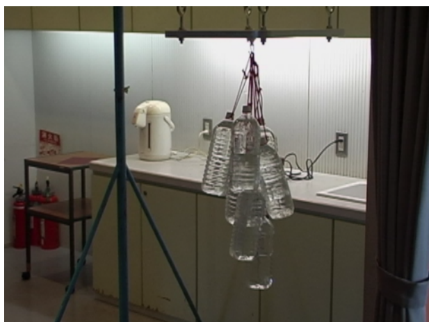
写真5. ペットボトルを7本ぶら下げた吸盤
